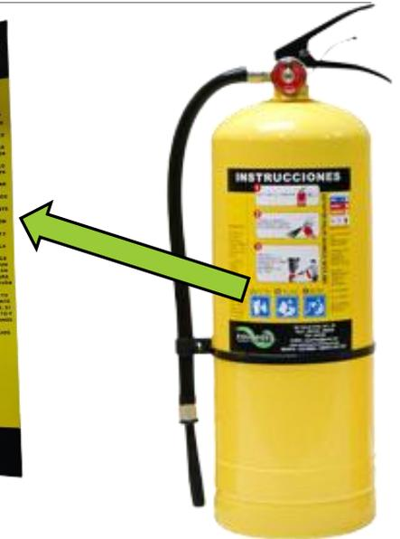
Las etiquetas de los sistemas de identificación de materiales peligrosos (HMIS), las etiquetas del mantenimiento de los seis años, las etiquetas de las pruebas hidrostáticas u otras etiquetas no deben estar ubicadas ni colocadas en el frente del extintor
